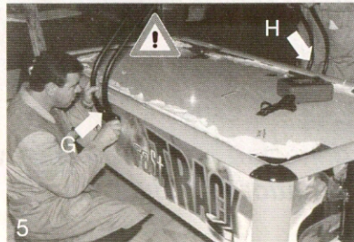
5 COLOCACION DE TORNILLOS POR ORDEN: 1º -G Y SUJETAR POR -H. SCREW SET-UP 1st -G AND HOLD THRU -H.
