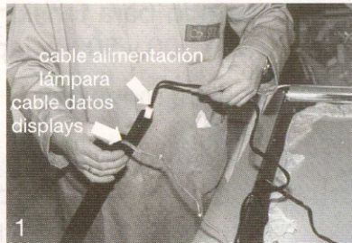
1 INTRODUCIR CABLES POR EL SOPORTE. INSERT WIRING THRU SUPPORT ( lamp feed wiring-display data wiring ).
